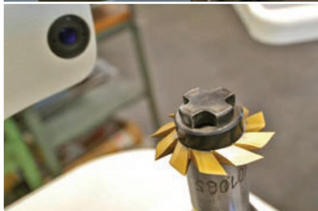
Mit **ULTRASONIC-Technologie** arbeitet Lechler im  $\mu$ -Bereich, mit entsprechenden Anforderungen an die Werkzeugvoreinstellung. Feinste Konturen erfasst die hochauflösende Kamera präzise.
