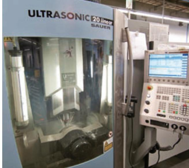
Die **Vorteile in der Bedienung** resultieren aus automatisierten Messabläufen und einem einfachen Handling, beispielsweise durch die schwenkbare zentrale Steuereinheit und ein servomanuelles Verfahren.
