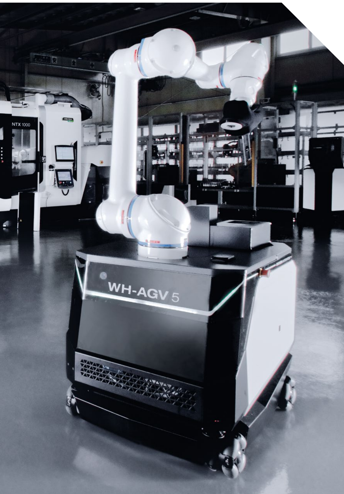
Das WH-AGV 5* benötigt keine Schienen und kann Menschen sowie Hindernissen automatisch ausweichen.
