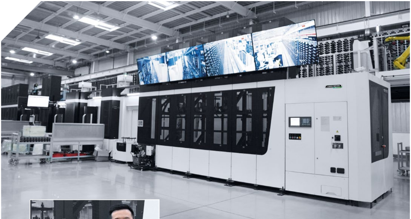
Automationslösung mit 4.000 Werkzeug- und 48 Palettenplätzen. Inklusive Leitreehner für die ganzheitliche Steuerung von Maschinen, Paletten und Werkzeugautomation.
