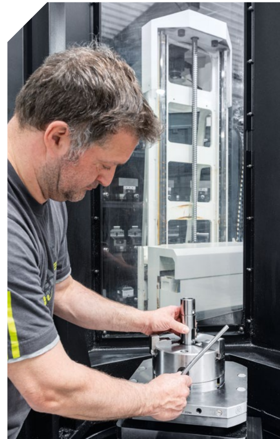
Der Rüstplatz des PH Cell 300 ermöglicht das hauptzeitparallele Rüsten.
