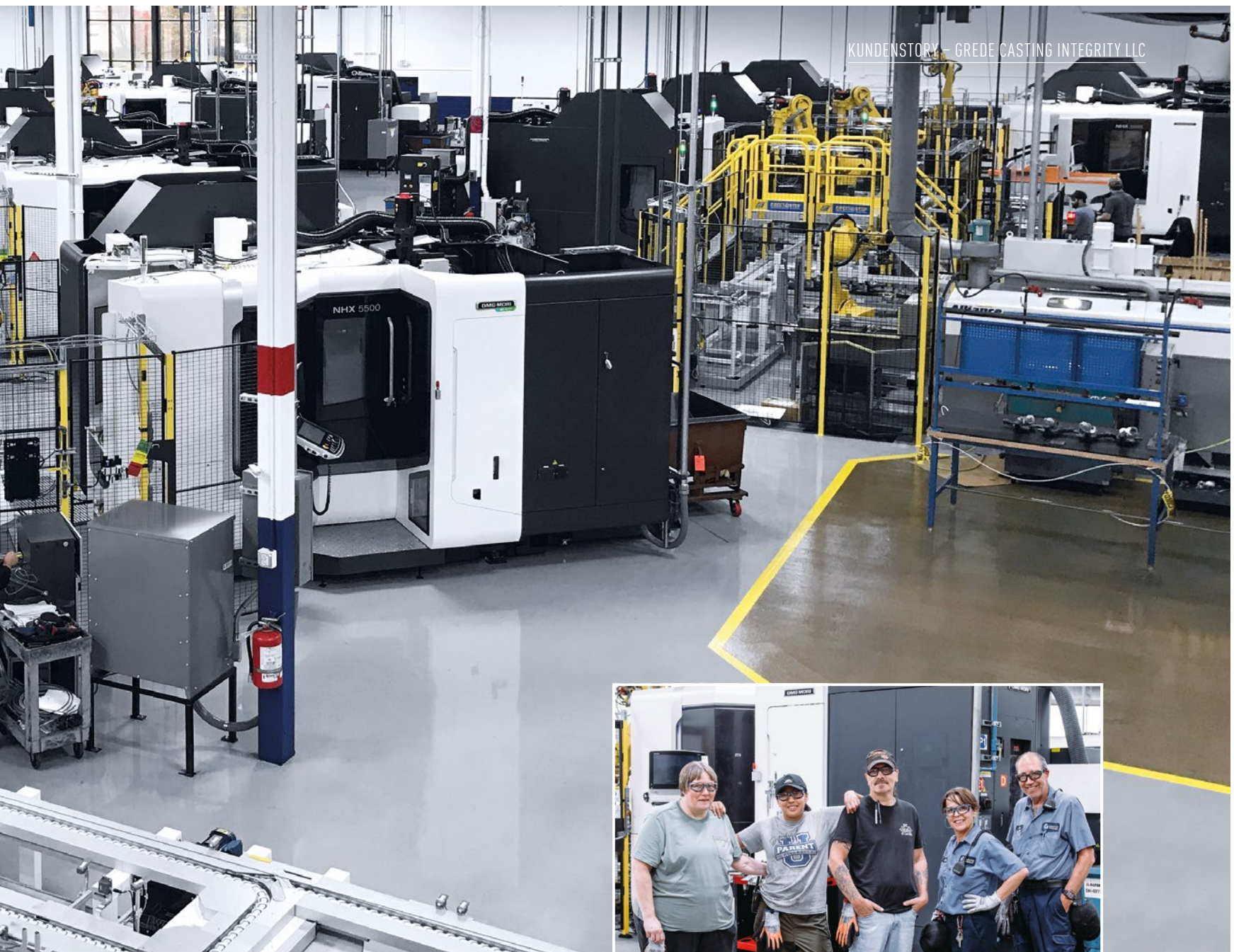
Fertigungslinie mit 18 NHX 5500 und 10 Robotern. Ein Roboter bedient jeweils 2 NHX 5500. Der zehnte Roboter übernimmt die Zuführung der Rohteile und übergibt die Fertigteile in eine separate Wasch- und Vermessungszelle.
