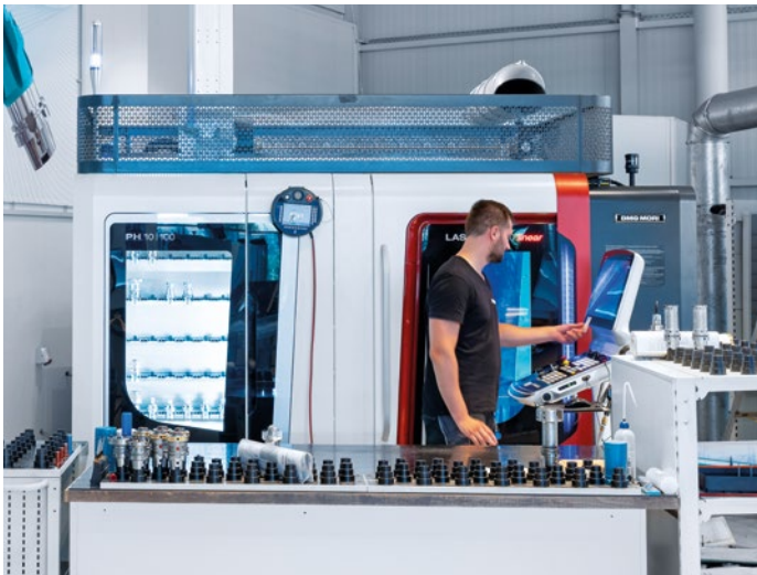
Die LASERTEC PrecisionTool Maschinen arbeiten automatisiert in mannlosen Nachtschichten, beispielsweise mit einem PH 10-Handlingsystem für 54 HSK-Werkzeuge an der LASERTEC 20 PrecisionTool.
