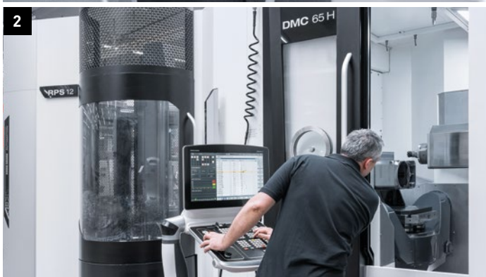
1. Bearbeitung von Grauguss- und Edelstahlgusskomponenten für die Vakuumgehäuse der Pumpen. 2. Der freie Spänefall des horizontalen Maschinenkonzeptes ermöglicht eine prozesssichere Produktion.
