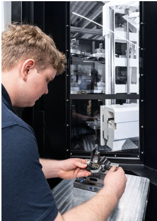
Über einen ergonomischen Rüstplatz wird der PH Cell 300 bestückt.
