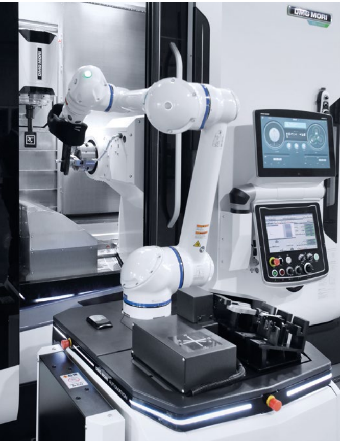
Der WH-AGV 5* transportiert die Werkstücke zu den beiden NTX 1000 2 nd Generation. Die Werkstücklänge wird automatisch auf der Werkstückablage gemessen.
