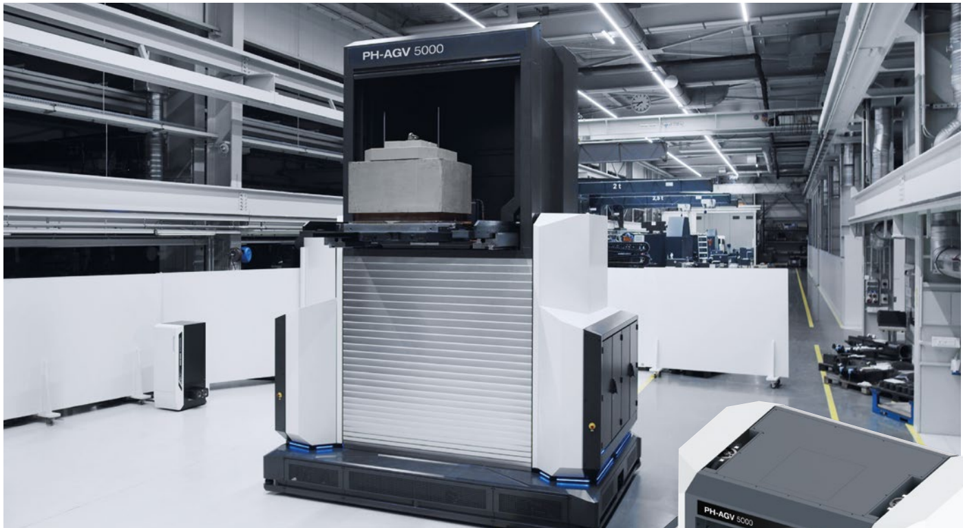
Großer vertikaler Hub von 2.010 mm zur Palettenablage in Regalen von bis zu 3 m Höhe.
