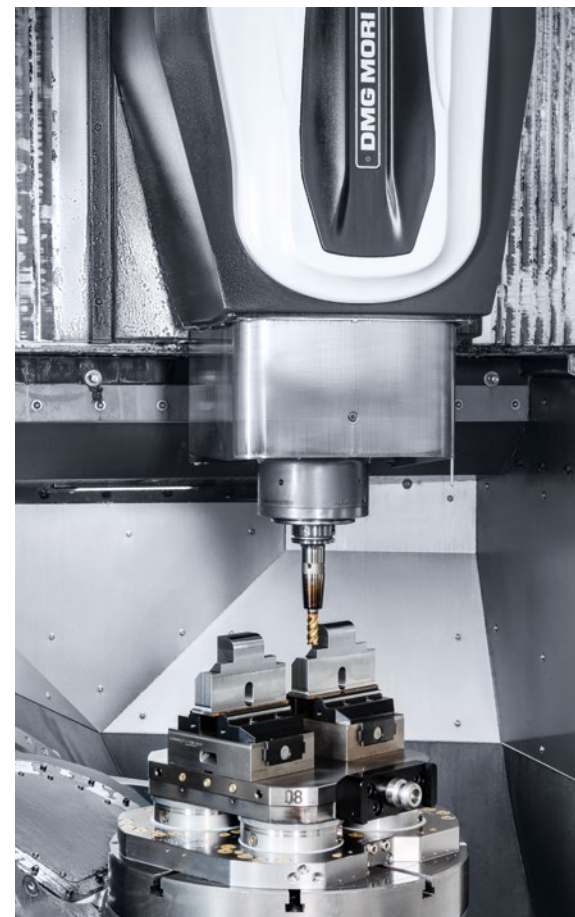
Durch die Nachrüstung des flexiblen PH Cell 300 kann Hintersdorf nun auch in mannlosen Nacht- und Wochenendschichten fertigen.
