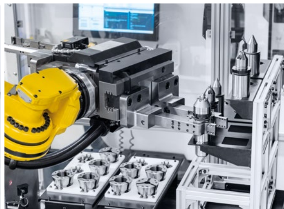
Der Roboter im MATRIS be- und entlädt die NTX 2000 mit Werkstücken und wechselt Werkzeuge im Revolver sowie Zentrierspitzen und Spannfutter.
