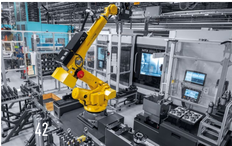
Sandvik Coromant: Automatisierte Fertigungslösung von Grundkörpern für Bohrwerkzeuge mit über hundert Varianten mit Losgrößen von 2 bis 80 mittels Dreh-Fräszentrum NTX 2000 und MATRIS, dem flexiblen und modularen Robotersystem von DMG MORI.
