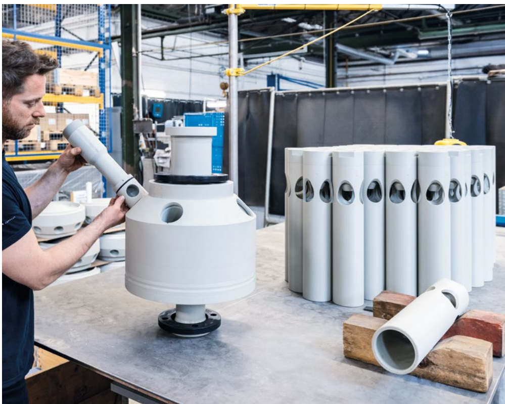
In der Montage werden die Ejektoren von Körting fertiggestellt.
