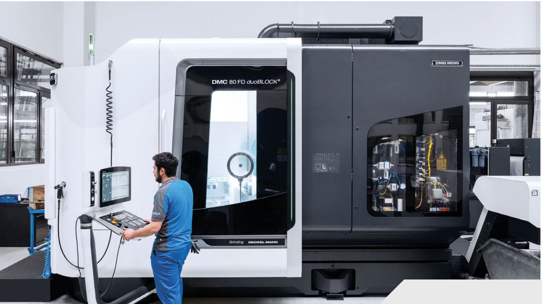
Seit 2022 nutzt Meindl-Köhle eine DMC 80 FDS duoBLOCK mit Schleiffunktion.
