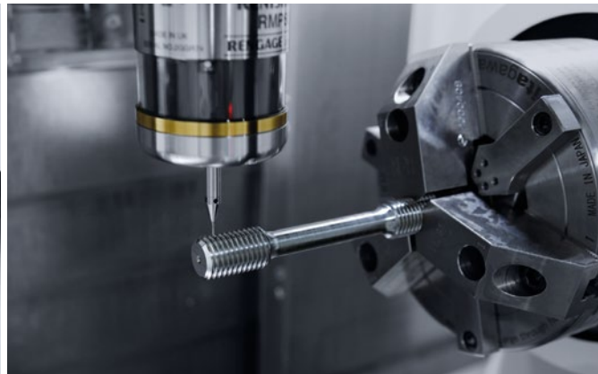
Die Messung der Gewindemaße wird in der Maschine mit einem Taststift mit kleinem Durchmesser von \varnothing 1\text{mm} durchgeführt.
