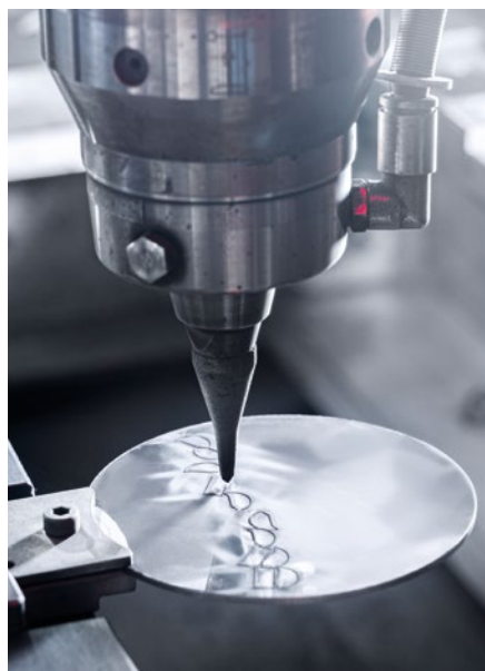
Die PKD- und CVD-Elemente der Werkzeuge werden auf einer LASERTEC 20 FineCutting aus den entsprechenden Ronden geschliffen.
