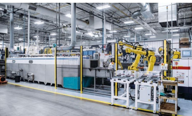
Die fertigen Achsschenkel werden im Anschluss gewaschen und automatisch vermessen.
