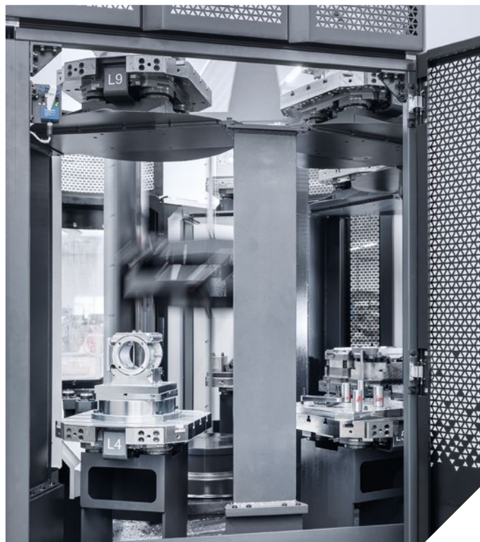
Dank des RPS 12 mit 12 Paletten wird die DMC 65 H monoBLOCK über mehrere Stunden optimal ausgelastet. Das Rüsten erfolgt hauptzeitparallel.
