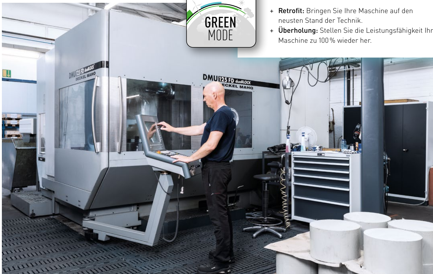
Mit der Überholung einer DMU 125 FD duoBLOCK durch die DMG MORI Used Machines hat Körting die Leistungsfähigkeit des Fräs-Drehzentrums um viele weitere Jahre verlängert.
