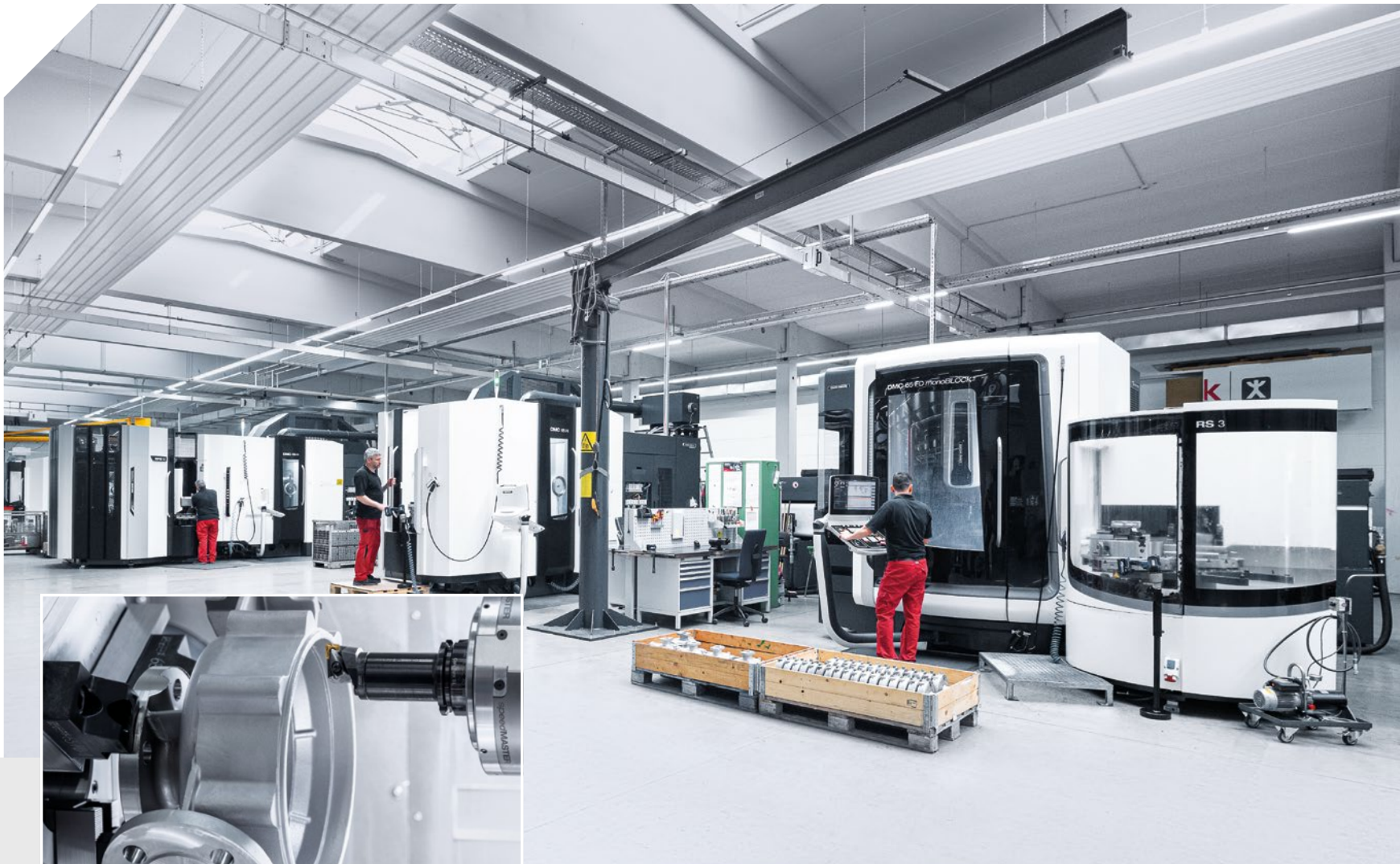
Für die Fertigung der hochpräzisen Pumpenkomponenten setzt die Firma SPECK Pumpen am Standort in Roth 75 Maschinen ein. Darunter eine DMC 65 FD monoBLOCK, die neue DMC 65 FD H monoBLOCK und eine DMC 65 H monoBLOCK mit Rundspeicher RPS 12.
