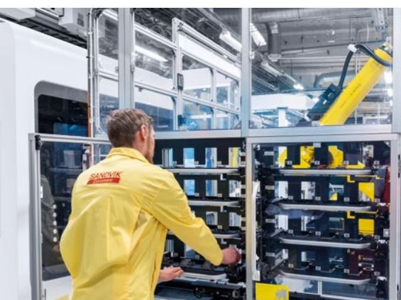
Automatischer Werkzeugwechsel für den Revolver. Separates Werkzeugmagazin mit Platz für 32 Werkzeuge, integriert im MATRIS.
