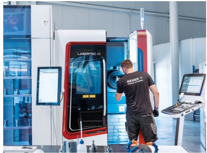
Auf einer LASERTEC 20 PrecisionTool und einer LASERTEC 50 PrecisionTool von DMG MORI erhalten die PKD- und CVD-Schneidkanten ihren finalen „Schliff“ in Form eines Laser-Finishings.
