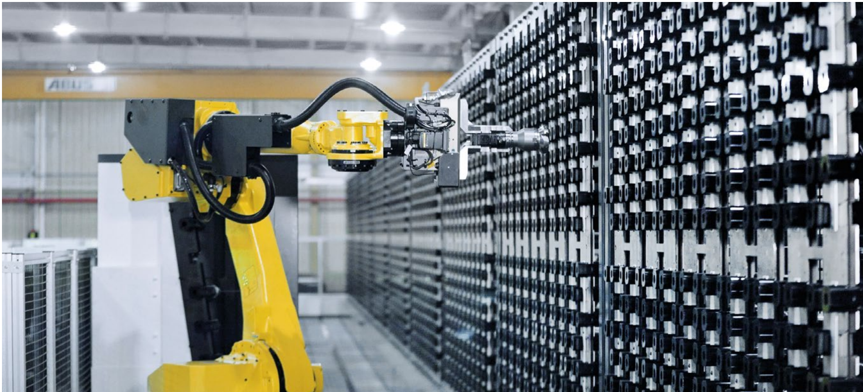
Der zentrale Werkzeugspeicher bietet Platz für bis zu 4.000 zusätzliche Werkzeuge. Die Bestückung der Werkzeuge erfolgt über eine maximal 60 Werkzeuge fassende Beladestation (TSS), in der die Werkzeuge per DMC-Reader erkannt und dem System nebst Daten automatisiert zu- und abgeführt werden.
