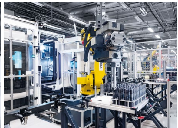
Sechs Wagen mit Grundkörpern finden in der Zelle Platz, sodass eine autonome Fertigung auch in den mannlosen Nachtschichten möglich ist.
