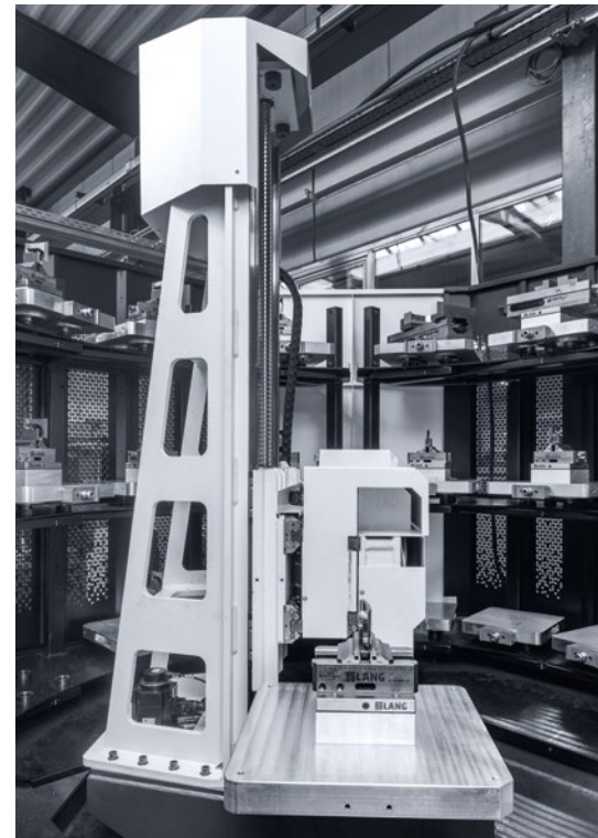
Das PH Cell 300 verfügt über 19 Palettenplätze – 15 für Paletten bis 300 × 300 mm, vier für Paletten bis 400 × 400 mm.
