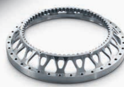
Bremsscheibentopf Drehen CTX beta 800 Fräsen DMU 80 eVo linear Material: Titan Laufzeit: 5-Achsen-Fräsen ca. 7 Stunden
