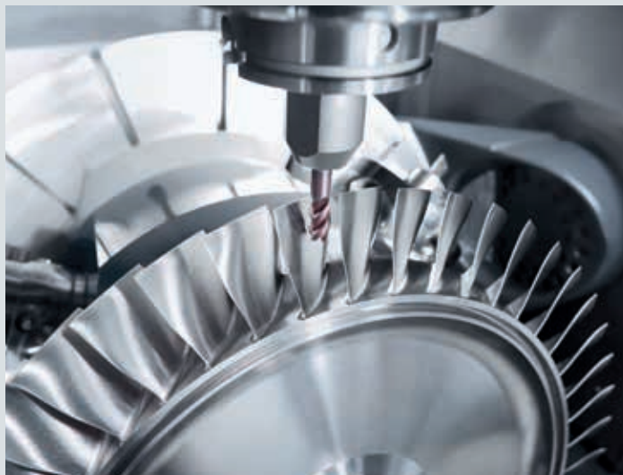
Höchste Stabilität und Dynamik der monoBLOCK®-Baureihe sind ideale Voraussetzungen für die Bearbeitung von BLISK-Bauteilen.
