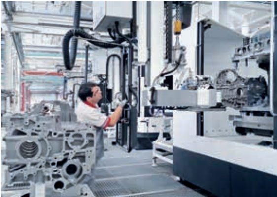
Am Rüstplatz werden die Bauteile beladen. Im Vordergrund eine Dreh- und Wendestation.
