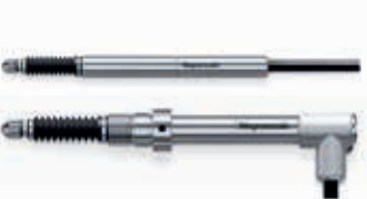
Für Anwendungen in der automatisierten Qualitätskontrolle in Produktions- und Montagelinien. Messbereiche: 5 mm bis 205 mm Genauigkeit: bis zu ±0,5 µm Lebensdauer: bis zu 90 Mio. Hübe
