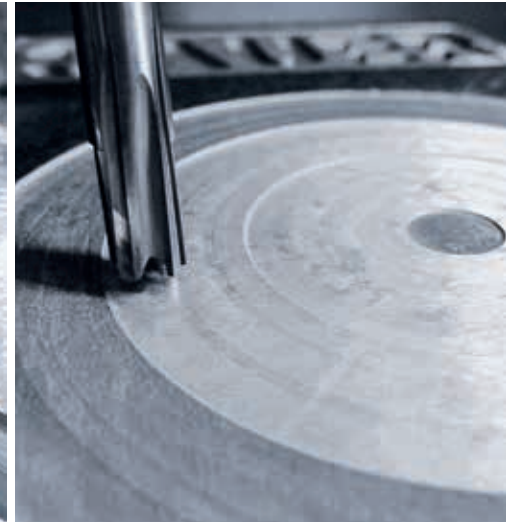
Besäumen und Schäften in CFK ohne Kantenausbruch, Faserausriss oder Delamination.
