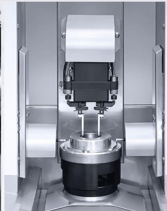
Messstation für das hauptzeitparallele In-Prozess Messen.
