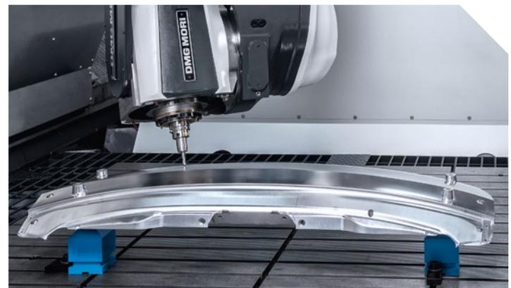
Die & Mold: 5-Achs Simultanbearbeitung
