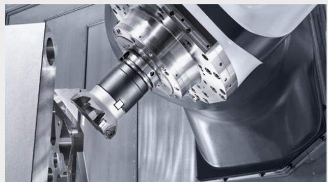
speedMASTER-Spindel mit 20.000 min<sup>-1</sup> und 130 Nm | 35 kW (40% ED).
