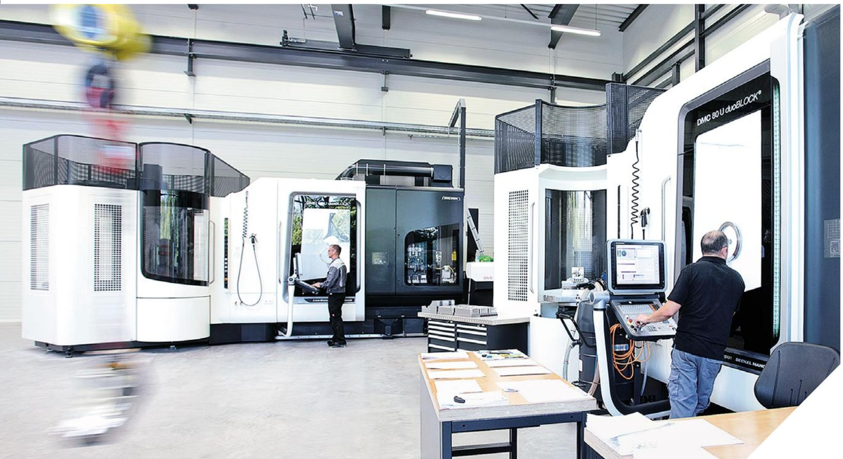
Ausgestattet mit RPS 12 Rundspeichern für bis zu zwölf Paletten können die beiden DMC 80 U duoBLOCK rund um die Uhr produktiv arbeiten.
