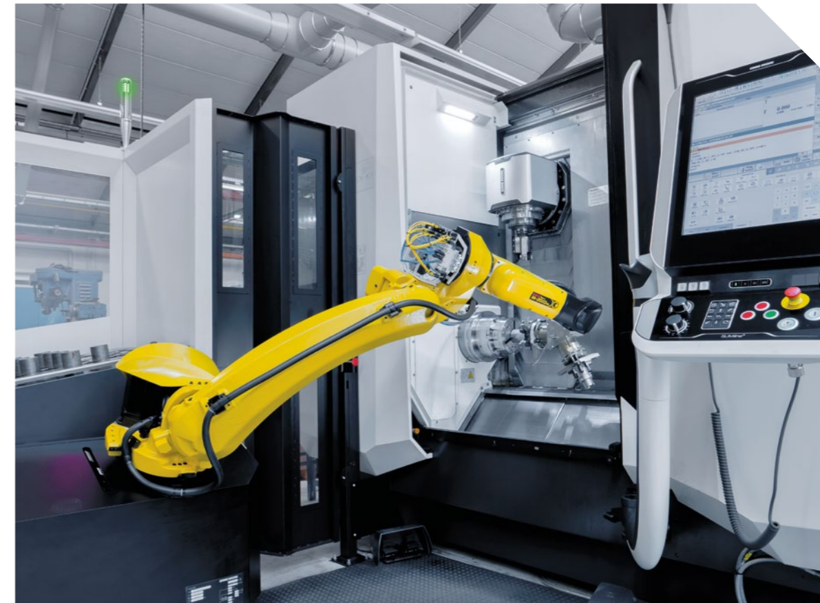
Auf der CLX 450 TC werden tagsüber Kleinserien mit kurzen Laufzeiten gefertigt. Nachts und am Wochenende werden Losgrößen mit bis zu 30 Teilen und längeren Laufzeiten völlig mannos produziert.
