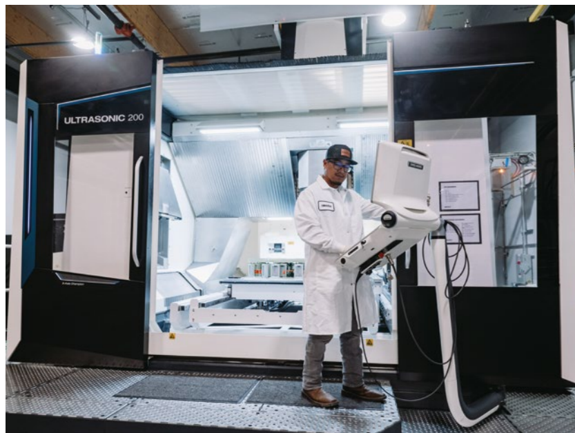
Die ULTRASONIC 200 Gantry bietet Verfahrswege von 4.000 x 2.000 x 1.200 mm. Das stabile Fundament der Gantry-Konstruktion ist eine optimale Basis für die hochpräzise Bearbeitung der Spiegelsegmente
