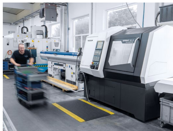
SPRINT 3218: Bis zu 28 Werkzeugpositionen auf 2 unabhängigen Linearträgern ermöglichen die hochproduktive Fertigung von Werkstücken bis ø32 mm.
