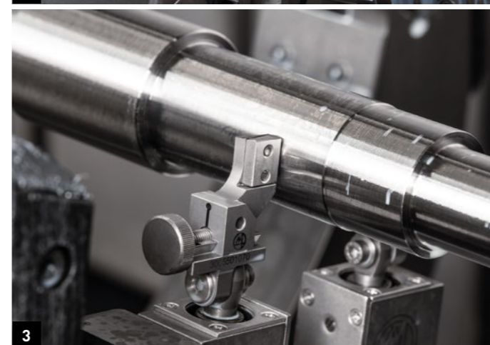
1. Die Größe der CTX gamma 3000 TC war notwendig, um Spindeln mit einer Länge von bis zu 1.000 mm zu bearbeiten, sodass ein ausreichender Verfahrweg in der X-Achse für Tieflochbohrungen erforderlich ist. 2. Das Dreh-Fräszentrum für die 6-Achsen-Komplettbearbeitung integriert die verschiedenen Prozesse, inklusive Schleifen, in einem Arbeitsraum. 3. In-Prozess-Messung der Oberflächenqualität. 4. Separates Fach für übergroße Werkzeuge im Arbeitsraum zur Durchführung des Schleifprozesses mit größeren Scheiben, um Zeit zu sparen und die Werkzeugkosten zu senken.
