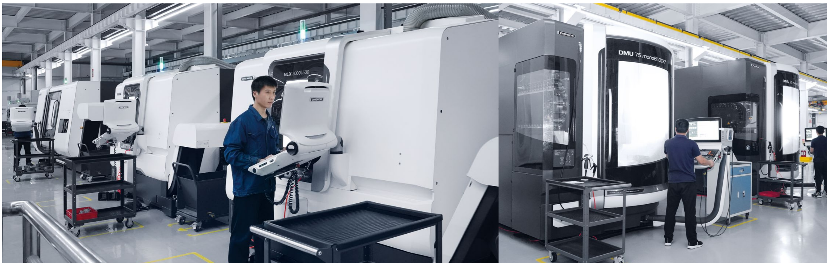
GRANDE-TEK Flow Control Co., Ltd. ist auf die Entwicklung und Herstellung von Ventilen und Durchflussregelungen spezialisiert. Für die Dreh- und Dreh-Fräsbearbeitung kommen unter anderem zwei NLX 2000 | 500 sowie eine CTX beta 1250 TC zum Einsatz.
