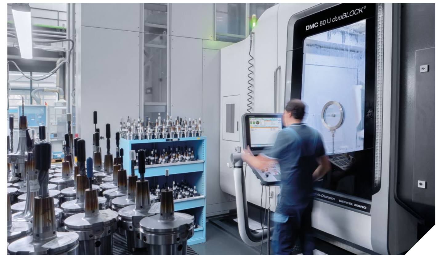
Komponenten aus Titan, Stahl und Aluminium werden unter anderem auf zwei Palettensystemen mit jeweils fünf DMC 80 U duoBLOCK bearbeitet.
