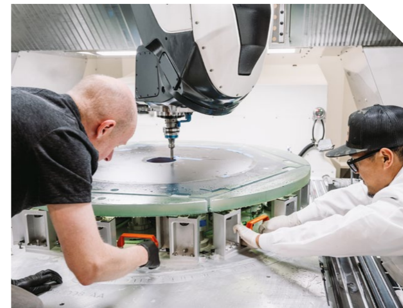
Die Ingenieure von Coherent haben ein eigenes Spannverfahren entwickelt, das eine Kombination von Stütz- und Klemmsystemen verwendet, um das Bauteil zu fixieren.
