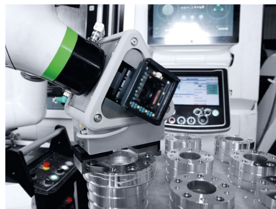
Vision-Kamera erkennt automatisch die Werkstücklage und passt die Armbewegung an, um die Produktion auch bei einer Fehlausrichtung fortzuführen.
