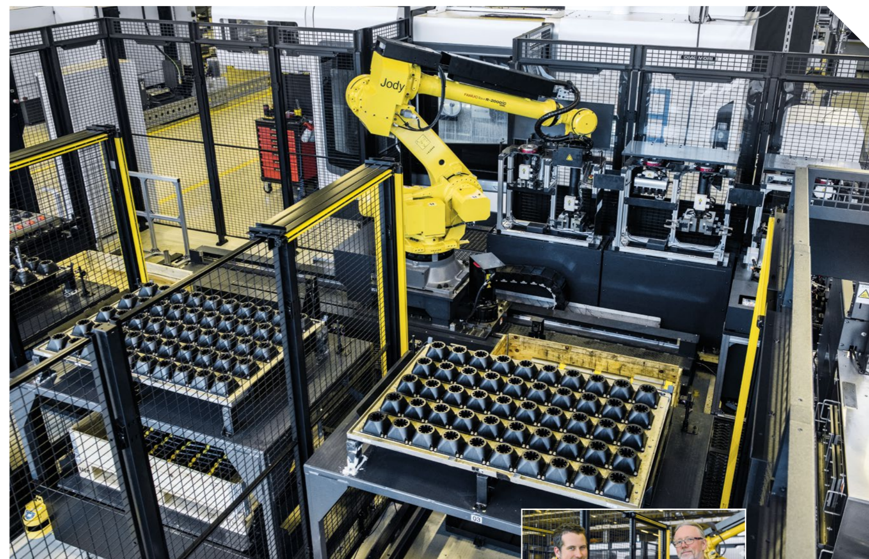
Die automatisierte NTX 3000 bearbeitet bis zu 150 Bauteile und sorgt damit für eine Auslastung über vier mannlose Schichten.
