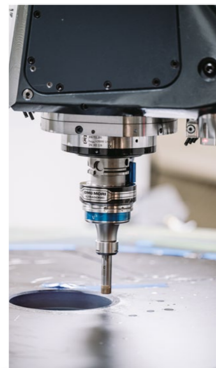
Bei der ULTRASONIC-Bearbeitung schwingt das Diamantwerkzeug entlang seiner Achse mit hoher Frequenz und geringer Amplitude – zusätzlich zur Hochgeschwindigkeitsrotation des Werkzeugs.
