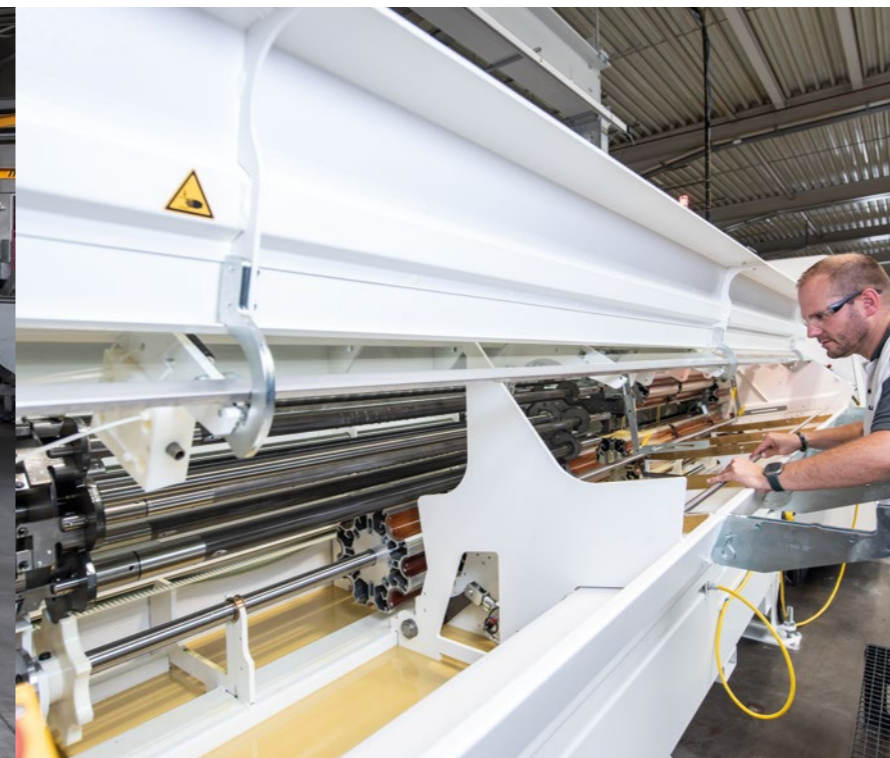
Der Stangenlader hat acht Führungskanäle, sodass die Maschine unterschiedliche Aufträge flexibel abarbeiten kann.
