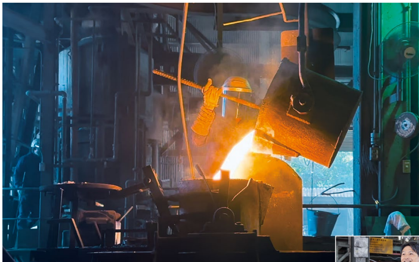
Gießprozess mit dem Schmelzen und Gießen des Metalls bei Temperaturen über 1.000°C
