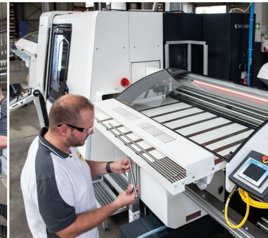
Längere Werkstücke werden durch die rechte Spindel der CTX beta 800 4A ausgegeben und im Entladesystem gesammelt.
