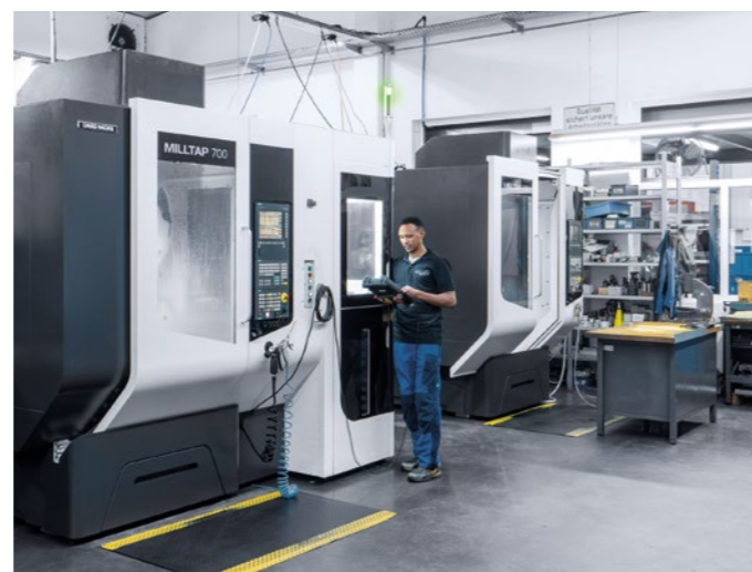
Für die 5-Achs-Bearbeitung kleinerer Werkstücke kommt bei Mechanik-Moduls die MILLTAP 700 zum Einsatz, automatisiert mit einem WH 3 Cell.
