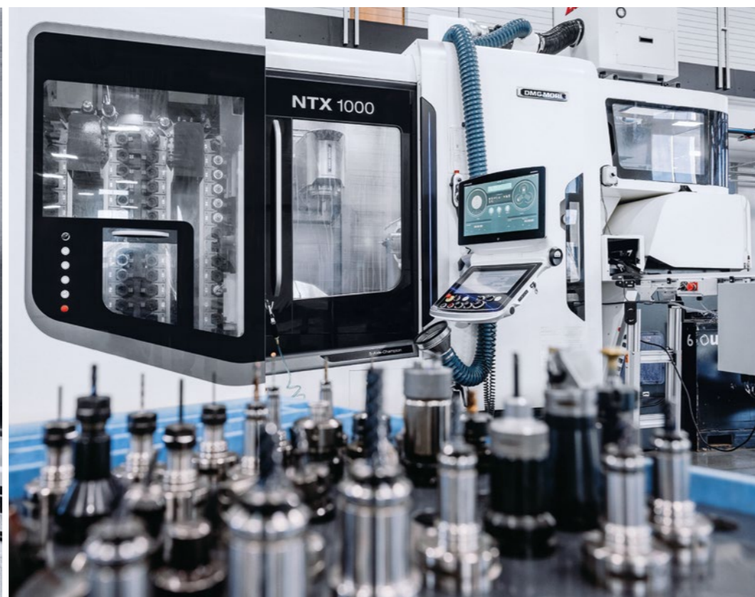
Die Materialien verursachen raschen Werkzeugverschleiß. Beim Betrieb ohne Bediener sorgen die Systeme zur Überwachung der Werkzeugstandzeit und zum Wechsel auf Schwesterwerkzeuge für höchste Prozesssicherheit.
