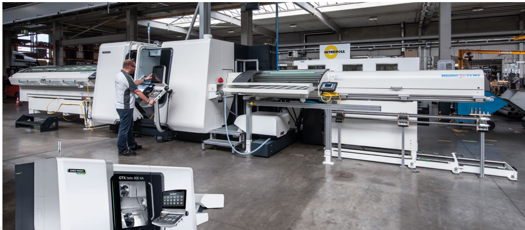
Auf der CTX beta 800 4A fertigt Interroll Komponenten für Trommelmotoren von der Beladung bis zur Entnahme vollautomatisch.
