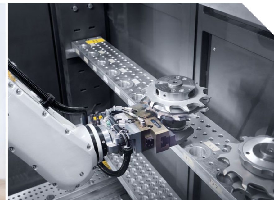
Maximale Auslastung im mannlosen Mehrschichtbetrieb durch automatisiertes Bauteilhandling
