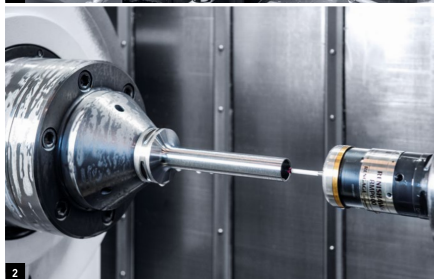
1. Dank ihres großen Arbeitsraums kann Sandvik Coromant Trondheim auf der NTX 3000 problemlos Werkzeugkörper mit Durchmessern von \varnothing 16 mm bis \varnothing 80 mm bearbeiten. 2. Sandvik nutzt bei jedem Werkstück eine In-Prozess-Messung. Der Messaufwand außerhalb der Maschine reduziert sich damit auf gelegentliche Stichproben.
