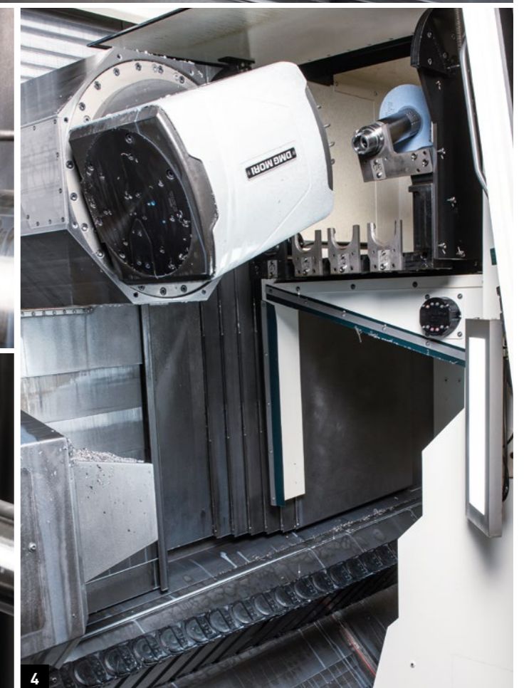
1. Die Größe der CTX gamma 3000 TC war notwendig, um Spindeln mit einer Länge von bis zu 1.000 mm zu bearbeiten, sodass ein ausreichender Verfahrweg in der X-Achse für Tieflochbohrungen erforderlich ist. 2. Das Dreh-Fräszentrum für die 6-Achsen-Komplettbearbeitung integriert die verschiedenen Prozesse, inklusive Schleifen, in einem Arbeitsraum. 3. In-Prozess-Messung der Oberflächenqualität. 4. Separates Fach für übergroße Werkzeuge im Arbeitsraum zur Durchführung des Schleifprozesses mit größeren Scheiben, um Zeit zu sparen und die Werkzeugkosten zu senken.
