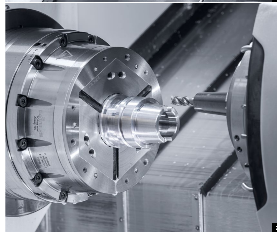
1. Die Greifer des Robo2Go können das gesamte Bauteilspektrum von ∅25 – 100 mm handhaben. 2. Auf der CLX 450 TC werden unter anderem HSK-Werkzeugaufnahmen in den Größen 32 bis 160 gefertigt.
