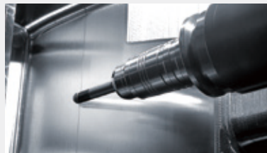
Profilierung (Form) Vorschlichten von hochfestem Material (40HRC) ø 16 Kugel-Fingerfräser
