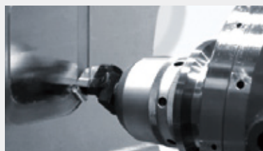
Federhalsbearbeitung mit Cs-Steuerung Hartmetallwerkzeug Material: SUS3040
