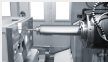
Bearbeitung mit Vorschub der W-Achse (Bohrspindel)
