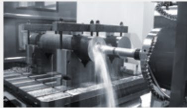
Tieflochbohren ø 110 mm Vollschnittbohrer / Material: S55C
